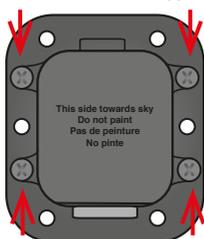
Le support peut être fixé au moyen des 4 vis de montage ou par collage avec l'adhésif fourni.
